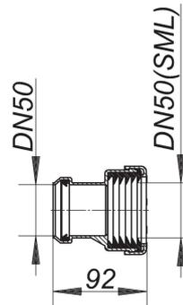
zur Verbindung von Gussrohren (SML) mit Kunststoffrohren (HT), inkl. Dichtungen
